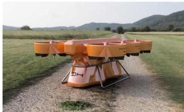
O projeto WILD HOPPER, financiado pela UE, está desenvolvendo uma plataforma pioneira de combate a incêndios florestais, um UAV multirotor, que utiliza tecnologia própria capaz de superar a principal barreira tecnológica do setor, a falta de baterias elétricas capazes de fornecer carga útil e tempo de voo necessário.
